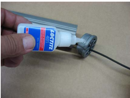
Klebung mit Loctite Schnellkleber 401
