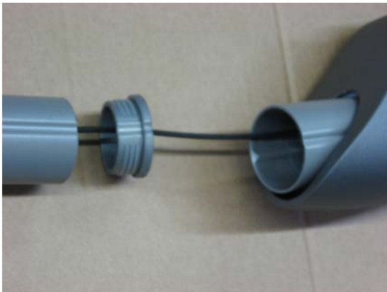
Klebung mit Loctite Schnellkleber 401
