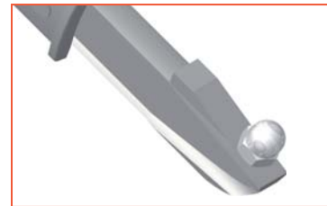
2b Variante QD mit Gewindestift und Hutmutter
