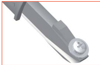
2a Variante Glatz mit Schraube und Unterlegscheibe
