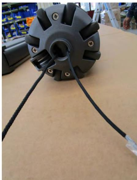
Wenn das Getriebe wieder zusammengebaut wird, auf die Rolle achten, da diese wegrutschen kann.
