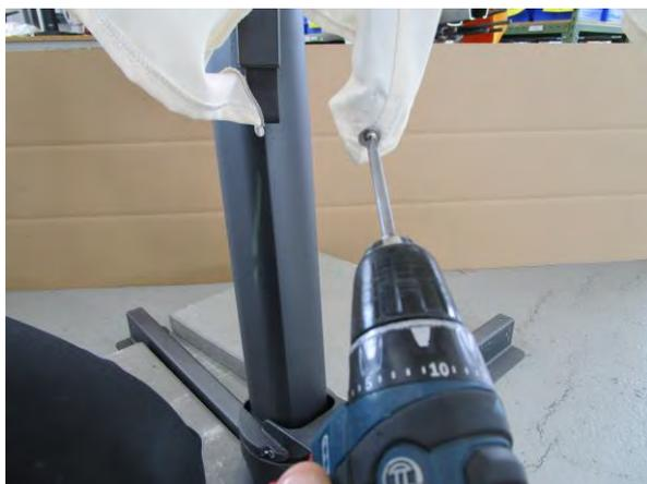
Um den Stoff ebenfalls am Tragarm zu entfernen, zuerst die Arretierung am Wagen lösen, diesen nach oben fahren, bis der Tragarm sich leicht absenkt. Anschliessend kann die Fixierschraube bequem gelöst werden.
