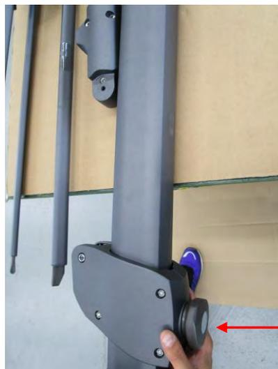
Nachdem der Wagen demontiert wurde, können die 3 Inbusschrauben unten am Tragarm gelöst werden.
