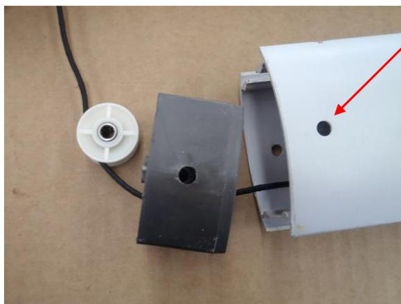
Kurbelgehäuse vorsichtig lösen und abnehmen. Vorsicht: Beim Entfernen des Gehäuses darauf achten, dass die kleine Sprungfeder nicht verloren geht.
