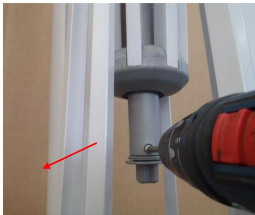
Strebe(n) nach aussen ziehen um die Seilspannung zu verringern. So gelangt man ans Seilende. Den Knoten lösen und den Haspel entfernen. Anschliessend die Strebe(n) langsam wieder sinken lassen.
