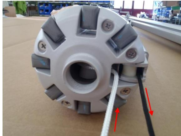
Falls das alte Seil gerissen ist, muss das neue ohne Hilfestellung des alten Seils eingearbeitet werden (mehr zeitlicher Aufwand)
