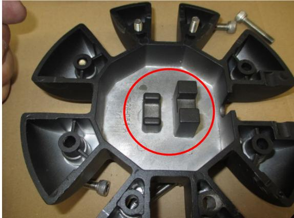
Das Seil in die entgegengesetzte Richtung des Innenstockes ziehen, so dass die Streben/Strebenbolzen in die Aussparung des Kronenkranzes gedrückt werden. Anschliessend die obere Kronenhälfte aufsetzen und Schrauben wieder vorsichtig festziehen.
