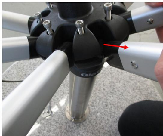
Nach dem Entfernen der defekten Strebe, umgehend die neue einsetzen. Anschliessend alle Schrauben wieder vorsichtig festziehen.
