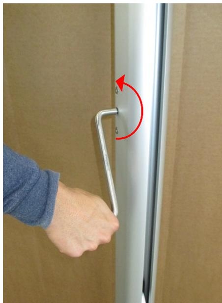
Wenn das Schirmteil geschlossen ist, weiterkurbeln bis das Zugseil lose aus der Mastnut tritt. Die beiden Haken der Seilbefestigungen ausklinken.
