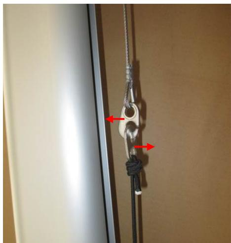
Schirmteil umfassen und anheben bis die Zylinderschraube aus der Aussparung für die Schirmaufhängung schaut (Bajonett-Verschluss). Dann 90° drehen und nach unten ausfahren.
