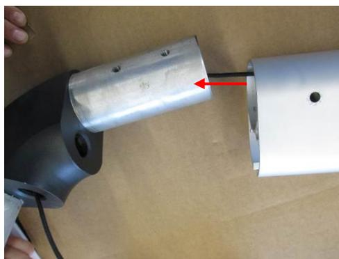
Nun die Anschlag-Schraube in der Mastnut, und am Getriebe die Fixierschraube lösen und entfernen.
