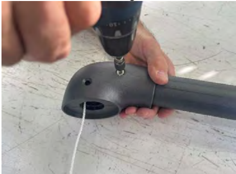
Korrekte Seilführung Seil oberhalb der vorgesehenen Löcher für die Schrauben und Führung durch Kerbe
