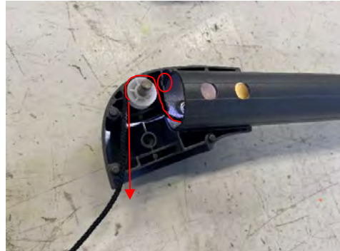
Falsche Seilführung Seil unterhalb der vorgesehenen Löcher für die Schrauben und Führung nicht durch Kerbe
