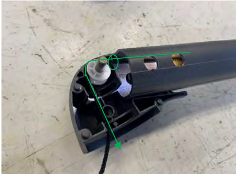
Korrekte Seilführung Seil oberhalb der vorgesehenen Löcher für die Schrauben und Führung durch Kerbe
