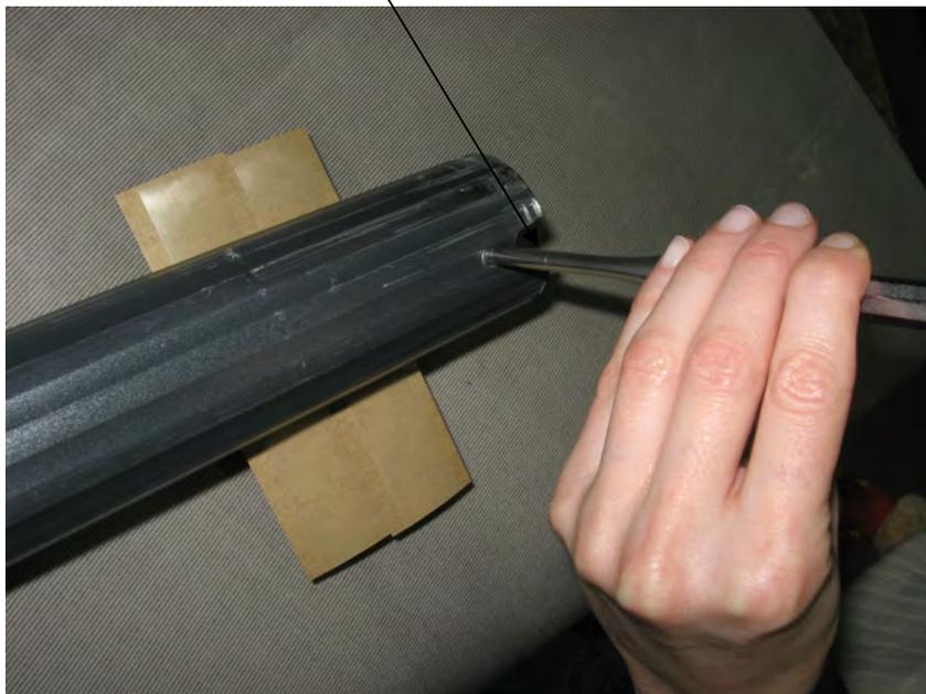
Innenansicht der Gasdruckfeder. Bestandteile: 1 Zylinderstift + 2 PVC-Distanzröhrchen (siehe Bild)
