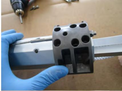
Die Seite des Verdrehlagers, welches bei der Platte ist als erstes mit den 6 Schrauben befestigen.
