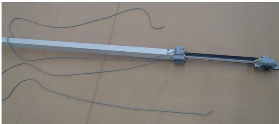
„Teleskoprohr komplett“ mit Getriebe, Zahnriemen und Seil aus dem Mast ziehen und durch ein neues „Teleskoprohr komplett“ ersetzen.
