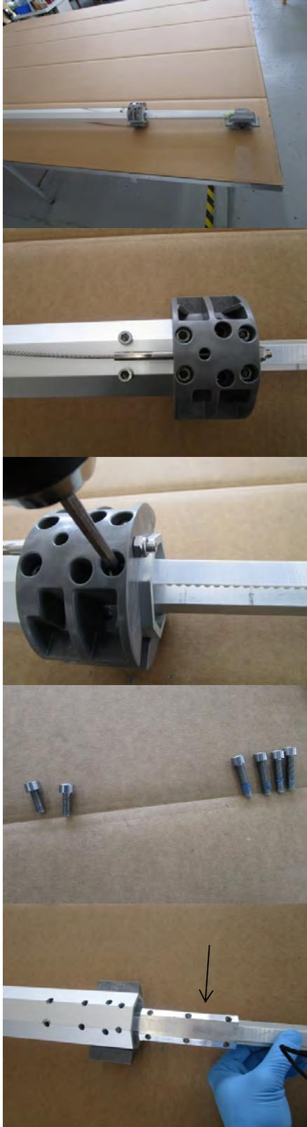
Teleskop so auf die Arbeitsfläche hinlegen, dass die Seite mit den 6 Inbusschrauben oben liegt.
