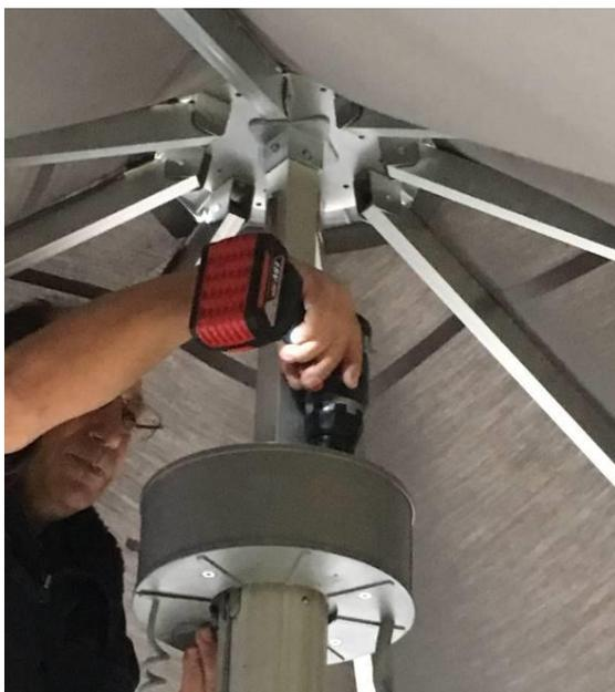
3. Steuerung vom oberen Mastende abschrauben. Tipp: Doppelseitiges Klebband an Schrauber kleben, damit die Schraube daran haften bleibt.
