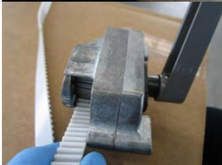
Um den Zahnriemen aus dem Getriebe zu entfernen, weiter kurbeln, bis der ganze Riemen aus dem Getriebe ist.
