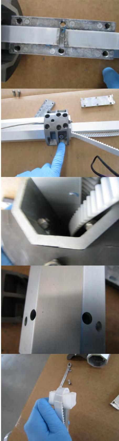
Die obere und untere Hälfte der Platte entfernen.
