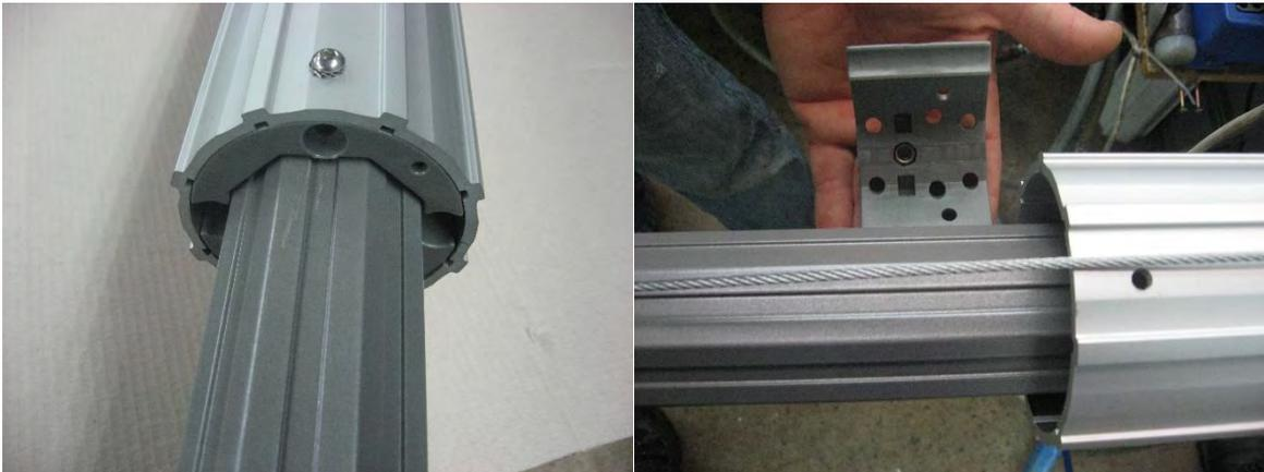
6. Rollenbock demontieren für Drahtseil- oder Getriebewechsel
