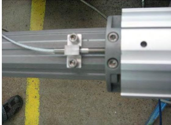
„Teleskoprohr komplett“ mit Getriebe, Zahnriemen und Drahtseil aus dem Mast ziehen und durch ein neues „Teleskoprohr komplett“ ersetzen.
