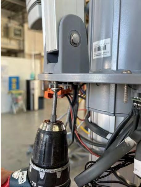
Anschliessend bei der Krone die Torx Schrauben abschrauben, die Fächer U-Scheiben entfernen und die Streben abnehmen.
