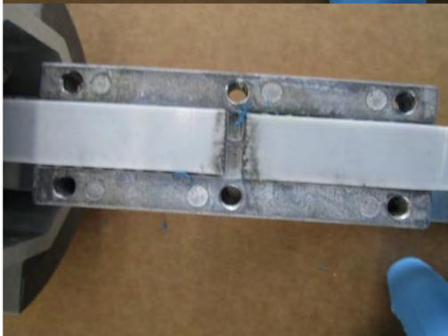
Die obere und untere Hälfte der Platte entfernen.
