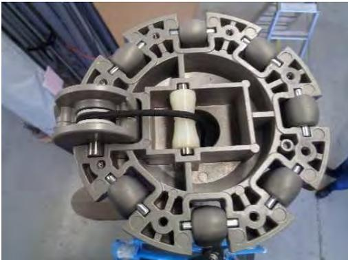
8 Senkschrauben (6-Kant) gemäß Bild, Punkt 3.3 lösen und entfernen, um Streben und Krone zu demontieren.
