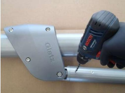
Nieten unten ausbohren, um Tragarm komplett zu entfernen.
