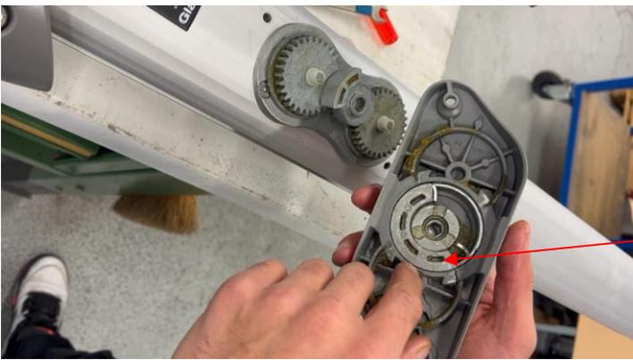
Darauf achten, dass der Deckel des Kurbelgetriebes wieder auf das Getriebe passt.
