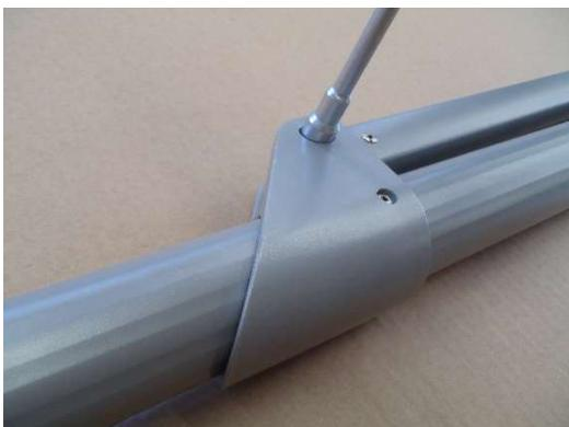
Zylinder Schraube (6-Kant) lösen, welche durch den Oberlenker führt und mit einer Stopmmutter befestigt ist.
