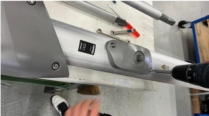
Den Deckel wieder aufsetzen und die Schrauben anziehen.
