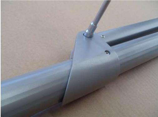
Zyl. Schraube (6-Kant) lösen, welche durch Oberlenker führt und mit Stoppmutter befestigt ist.
