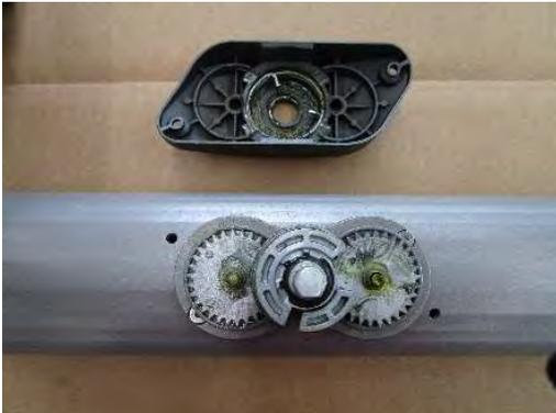
Obere Schale des Kurbelantriebes entfernen. Beide Alu-Halbteile und Zahnräder entfernen.
