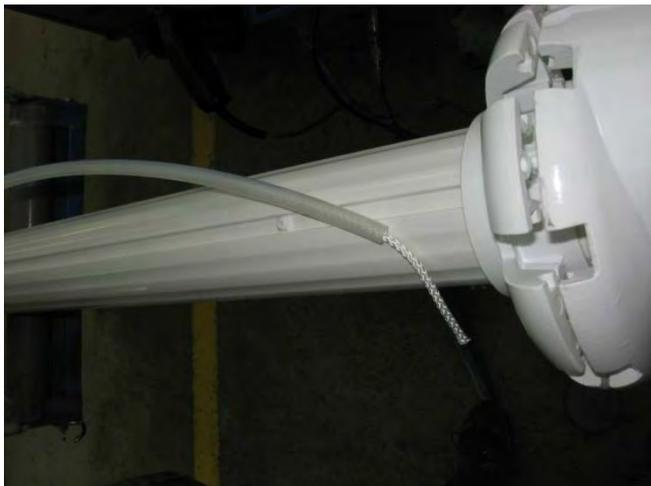
Seil aus dem Schieber (Seilschlauch)
