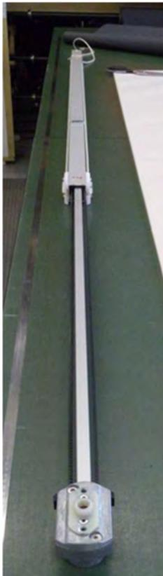
Wie abgebildet, wird dieses Teleskop als Ersatzteil komplett mit Getriebe und Zahnriemen verkauft
