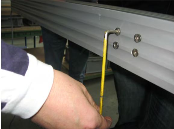
4 Senkschrauben zur Befestigung des Getriebes
