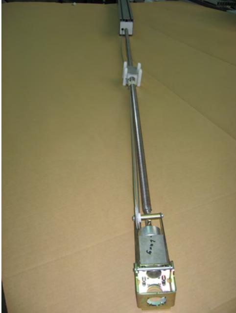
Spindel komplett montiert mit Drahtseil, Getriebe, Gewindemutter und Gleitsteinen.
