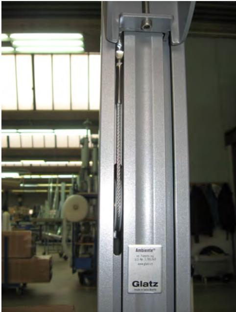
Unteres Drahtseil so einziehen und spannen, dass die Umlenkrolle beim Mastschlitz herauskommt und das andere Ende am Wagen befestigt wird.
