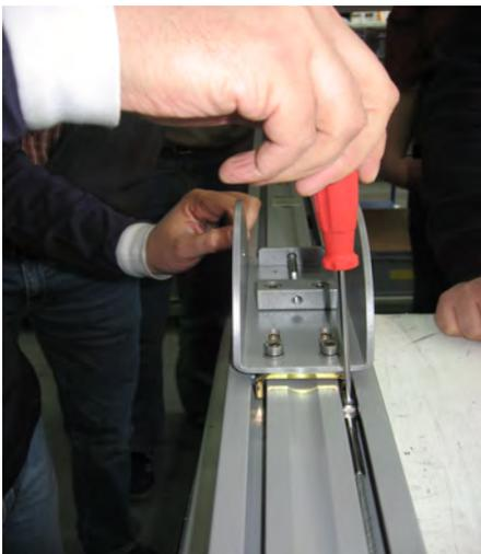
Drahtseilbefestigung am Wagen lösen, damit auf dem Drahtseil keine Spannung ist.
