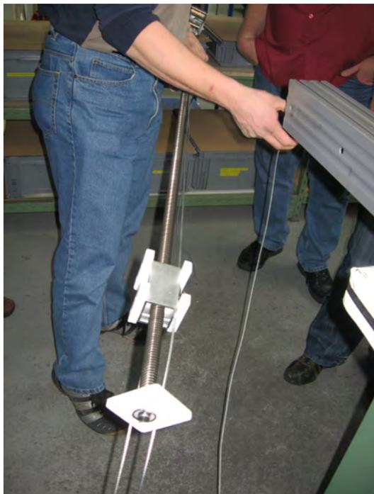
Spindel mit Getriebe + Drahtseil aus dem Mast
