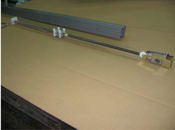
Spindel, Gleitsteine, Drahtseil, Getriebe / Wippen ersetzen
