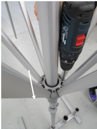
Schrauben am Schieber lösen, Strebe herausziehen.
