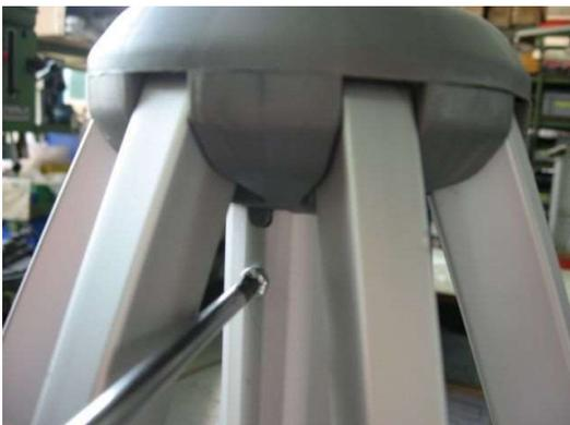
2 Schrauben herausdrehen, Nocken mit dem Cutter abschneiden. Schirmteil im geöffneten Zustand drehen, bis die Stoffkante waagrecht ist. Neu verschrauben.
