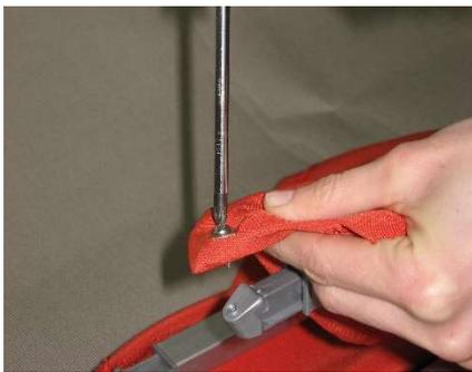
Top abschrauben und Schrauben an Strebenenden lösen.
