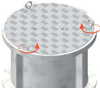
**2** Befestigen Sie ein Hebezeug an den Augenschrauben im Rand der Bodenhülse.
