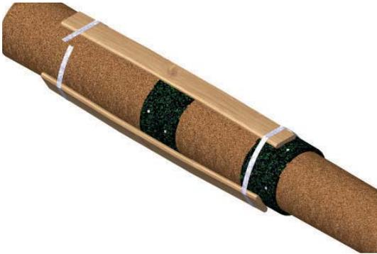
**2** Bringen Sie die Gummimanschetten im Bereich der Bodenhülsen-Oberkante und der Hülsenmitte an. Befestigen Sie diese mit Nägeln gegen verrutschen.
