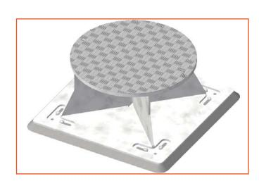
2 Legen Sie die Riffelblechdeckel auf die Flansche der Bodenplatten zu den Trägern und schrauben diese mit Hilfe eines Innensechskantschlüssels 6mm und den mitgelieferten Senkkopfschrauben M10 fest.
