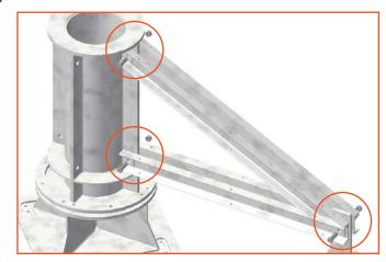
3 Koppeln Sie die Träger mit Hilfe von je 9x Verbindern (120 x 40 x 8 mm) und Schrauben M10/30, Keilscheiben und Muttern M10 untereinander. Hierzu benötigen Sie Schraubenschlüssel der Schlüsselweite 16mm.
