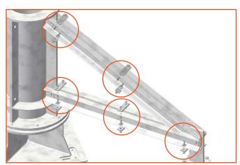
4 Am äußeren Verbindungspunkt oberhalb des Schwertes werden die Träger über einen Verbinder (120 x 40 x 10 mm) und Schrauben M10/30 , Keilscheiben und Muttern M10 gekoppelt. In den Verbinder wird mittig eine Ringschraube M10 zum Befestigen des Hebezeugs eingeschraubt.
