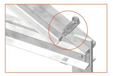
5 Montieren Sie alle weiteren Fachwerkträger und Verbinder zwischen dem Weihnachtsbaum-Aufsatz und den Schwertern.
