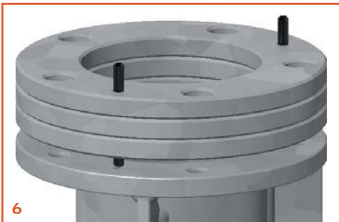
**7** Versenken Sie die herausstehenden Spannstifte, sodass diese in den Befestigungsflansch übergehen.
