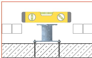
**3** Legen Sie je eine Unterlegscheiben und eine Mutter auf die Gewindestabenden oberhalb der Fußplatte.
