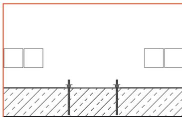
**2** Legen Sie die Fußplatte über die Gewindestäbe auf die Unterlegscheiben auf und nivellieren die Fußplatte mit Hilfe der unterliegenden Muttern, so dass der Flansch mit dem Deckbelag (OK Deckbelag  $\pm 0,00$  cm) abschließt und in Waage liegt..
