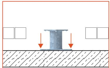
**4** Bohren Sie an den markierten Stellen mit einem 18er Bohrer mit Hartmetallspitze Löcher von 115 mm Tiefe in das Fundament.
