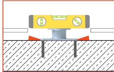
3 Unterfüttern Sie die Fußplatte ggf. mit Keilen, so dass der Flansch mit dem Deckbelag (OK Deckbelag  $\pm 0,00$  cm) abschließt und in Waage liegt.
