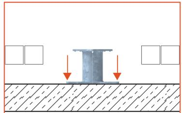
**4** Bohren Sie an den markierten Stellen mit einem 12er Bohrer mit Hartmetallspitze Löcher von 150 mm Tiefe in das Fundament.
