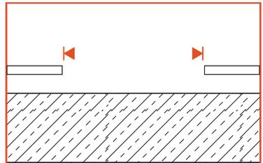
**3** Legen Sie die Fußplatte auf die gesäuberte Oberfläche, richten diese gemäß des vorangegangenen Einmaßes aus und markieren die 4 Befestigungspunkte deutlich auf dem tragenden Untergrund.
