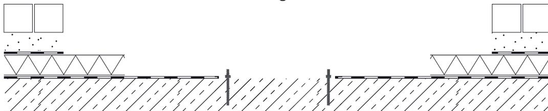
**2** Legen Sie die Bodenplatte über die Gewindestäbe auf die Unterlegscheiben auf und richten diese mit Hilfe der unterliegenden Muttern horizontal aus. Der Flanschring der Bodenplatte muss ebenerdig (OK Deckbelag  $\pm 0,00$  cm) abschließen.
