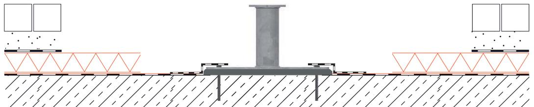
**3** Führen Sie die oberhalb der Dämmung aufgebrachte Dichtung herunter zur Dampfsperre. Achten Sie darauf, dass die neu aufgebrachte Dichtung mit der bestehenden Dampfsperre exakt abdichtet (Überlappung mindestens 15 cm).
