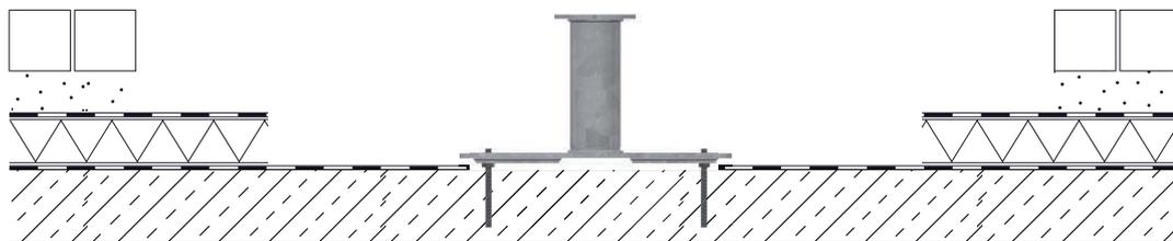
**3** Heben Sie die Platte von den Gewindestangen ab und verfüllen den Untergrund vollflächig mit pastösem Verbundmörtel.
