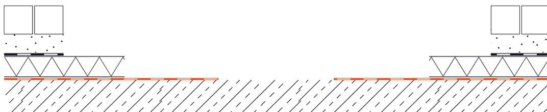
**3** Legen Sie die Bodenplatte auf die geräumte Betondecke, richten diese gemäß vorangegangenem Einmaß aus und markieren die notwendige Befestigungspunkte. > vgl. Tabelle Seite 3
