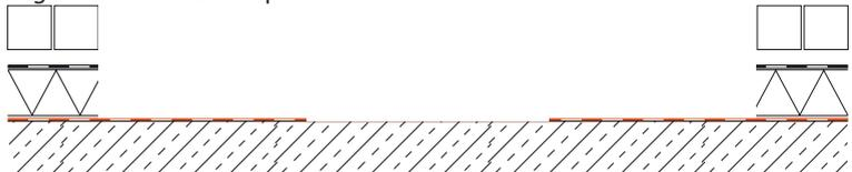
**3** Legen Sie die Bodenplatte auf die geräumte Betondecke, richten diese gemäß vorangegangenem Einmaß aus und markieren die notwendige Befestigungspunkte.
