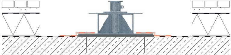
**2** Führen Sie die Dämmung bis auf einen Abstand von ca. 30 cm an die Bodenplatte heran.
