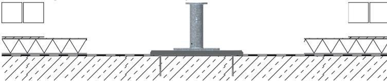
**6** Aus den Befestigungspunkten quellender Verbundmörtel muss in den Befestigungsschlitzn verfüllt und geglättet werden.
