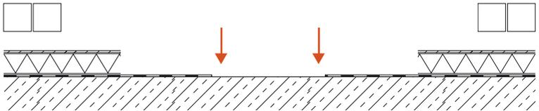
**4** Bohren Sie an den markierten Stellen mit einem 14er Bohrer mit Hartmetallspitze Löcher von 150 mm Tiefe in die Betondecke.
