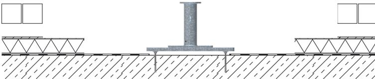
**3** Heben Sie die Platte von den Ankerstangen ab und verfüllen den Untergrund vollflächig, gezahnt mit pastösem Verbundmörtel.
