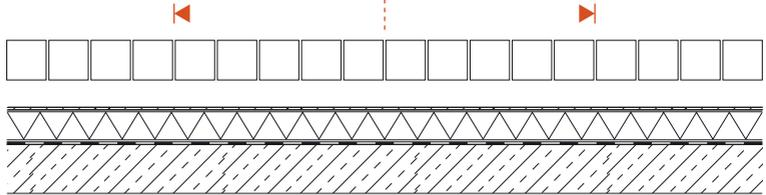
**2** Legen Sie die darunter liegenden Schichten frei. Säubern Sie den Untergrund gründlich und entfernen die Dichtung im Bereich der eingemessenen Bodenplatte.
