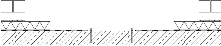
**2** Legen Sie die Bodenplatte über die Ankerstangen auf die Unterlegscheiben auf und richten diese mit Hilfe der unterliegenden Muttern horizontal aus. Der Flanschring der Bodenplatte muss ebenerdig (OK Deckbelag  $\pm 0,00$  cm) abschließen.
