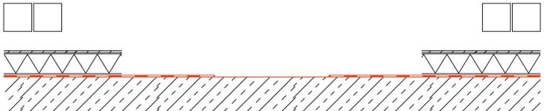
**3** Legen Sie die Bodenplatte auf die geräumte Betondecke, richten diese gemäß vorangegangenem Einmaß aus und markieren die notwendigen Befestigungspunkte.
