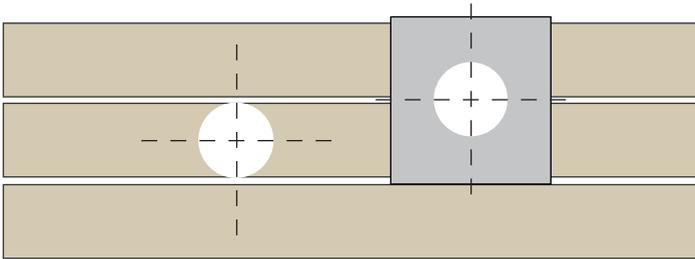
**2** Entfernen Sie den Deckbelag und lagern Sie diesen 1:1, entsprechend dem Verlegemuster, seitlich des Einbauortes.
