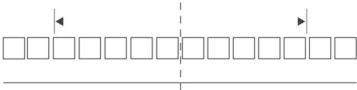
**2** Nehmen Sie den Deckbelag innerhalb der markierten Fläche auf und lagern Sie diesen 1:1, entsprechend dem Pflasterbild, seitlich des Einbauortes.
