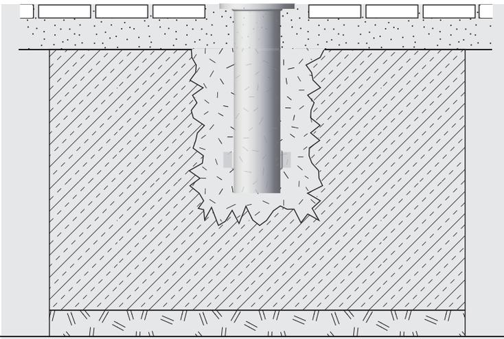
**Werkzeuge:** Kernbohrer Ø 220 mm (M8), Ø 250 mm (M16)
