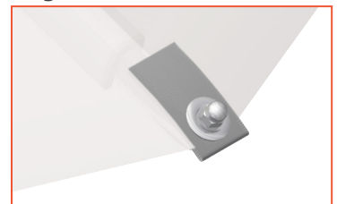
7b Variante QD mit Gewindestift und Muttermutter
