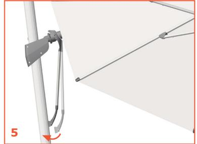
**5** Klicken Sie den Clip der Lenkstange in die Führungsnut am Schirmmasten ein. Das Schirmteil ist nun in dieser geneigten Position fixiert.
