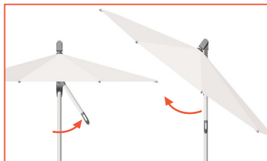
Auslenkbewegung nach rechts: Schirmteil kippt nach links
