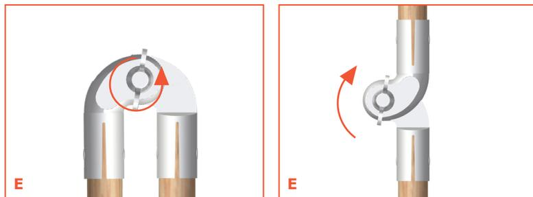
**F** Drehen Sie die Flügelmutter im Uhrzeigersinn um den Schirmmasten in seiner aufrechten Position zu fixieren.
